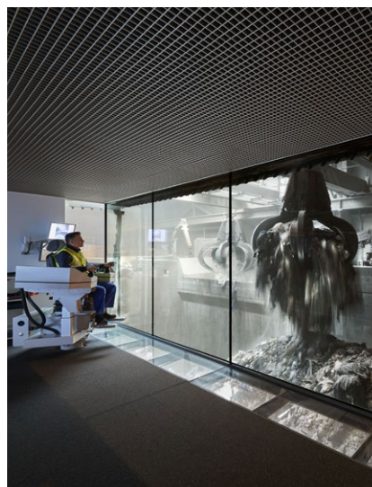
Riesige Stahlgreifer krallen Müll für die ofengerechte Verarbeitung.
